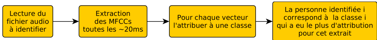
FIGURE 4.2 – La chaîne de traitement pour l’identification d’une voix humaine.
